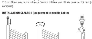
1 Introduire la résistance dans le radiateur retourné. 2 Visser la résistance en utilisant une clé de 25 mm (non comprise). 3 Brancher les cosses faston sur la résistance. Raccorder le filpilote (s'il est prévu).
