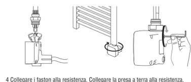
1 Inserire la resistenza nel radiatore capovolto. 2 Avvitare la resistenza utilizzando chiave da 25 mm (non inclusa). 3 Collegare i faston alla resistenza. Collegare il filpilote (se presente).
