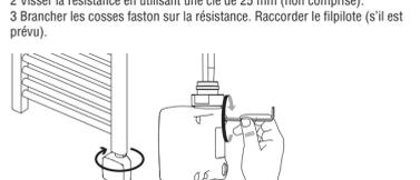
4 Visser Stone à la résistance jusqu'à son blocage. 5 Fixer Stone avec la vis située à l'arrière. Utiliser une clé six pans de 1,5 mm (non comprise).
